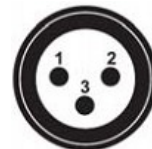
DMX – вход панельный разъем XLR «папа»
